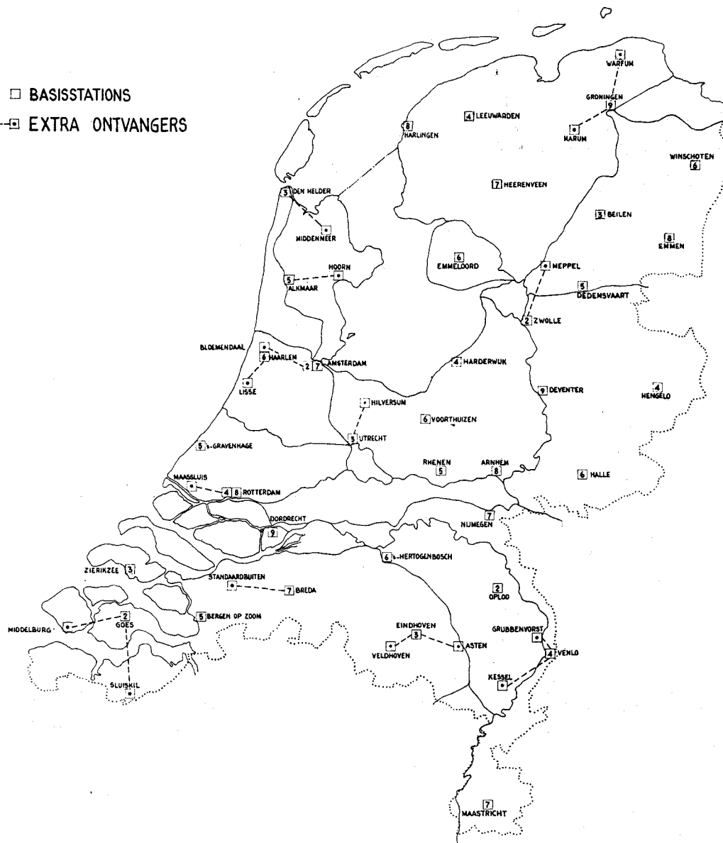
Fig. 2. Basisstations van het openbaar landelijk mobilfoonnet sinds 1955.
